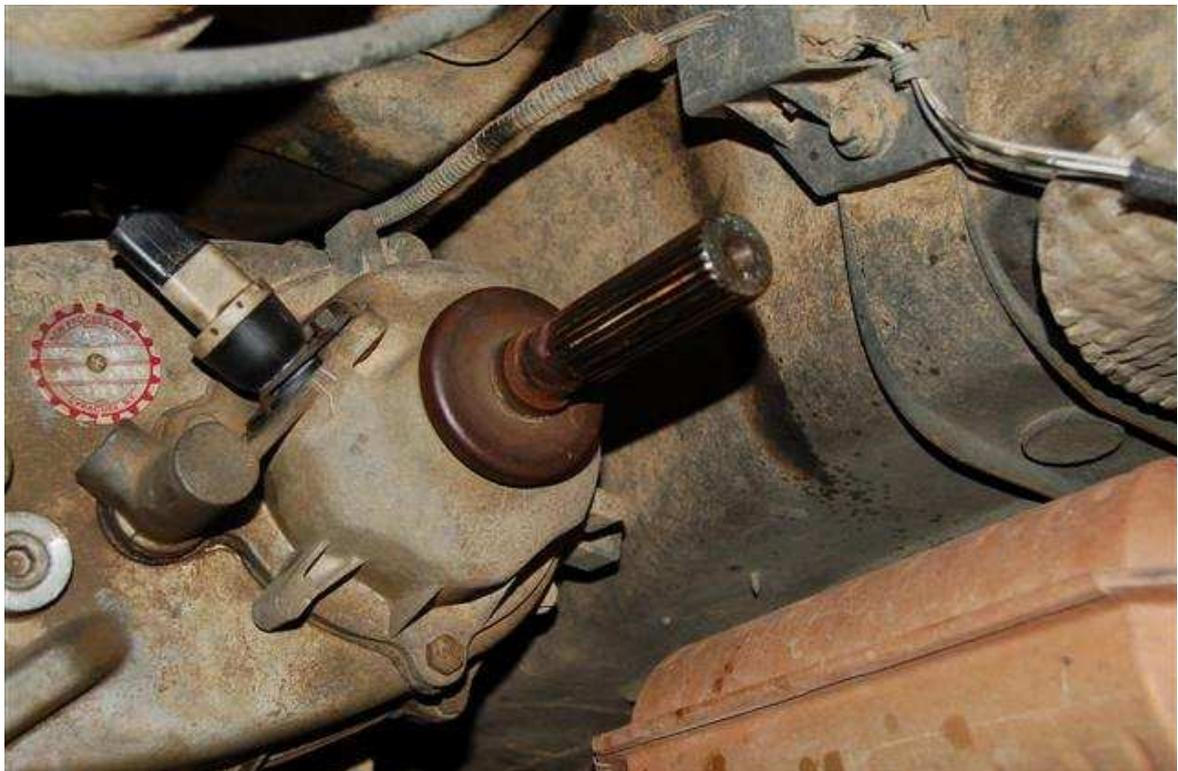
Ca. 3 cm der Verzahnung sollen übrigbleiben. Das entspricht der Länge der Verzahnung des neuen Flansches. Ich habe mir das mit Panzerband markiert, um sicher zu gehen das der Abschnitt winklig wird.
