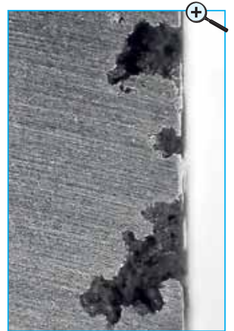
Abb. 3 Querschnitt der Zylinderlaufbuchse
