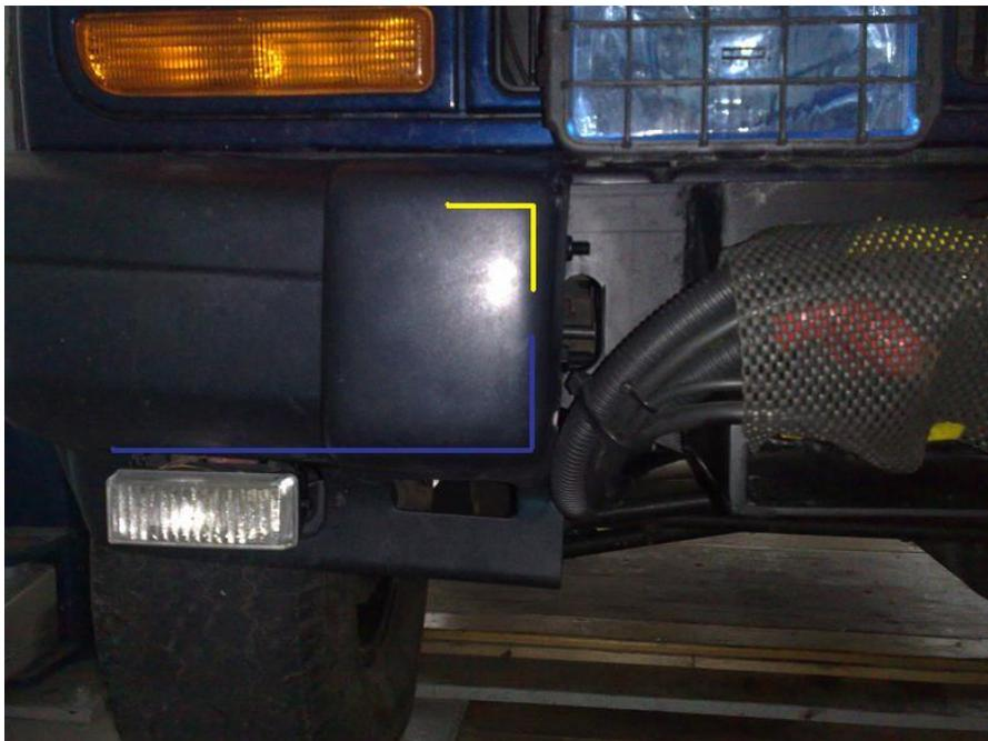
Wir haben zwei Flacheisen eingesetzt, eines unten (blau) welches bis zur Seite geführt wurde und somit beide Schraubpunkte der Plastikecke abdeckt und in diesem Fall auch den Nebelscheinwerfer wieder mit aufgenommen hat...
