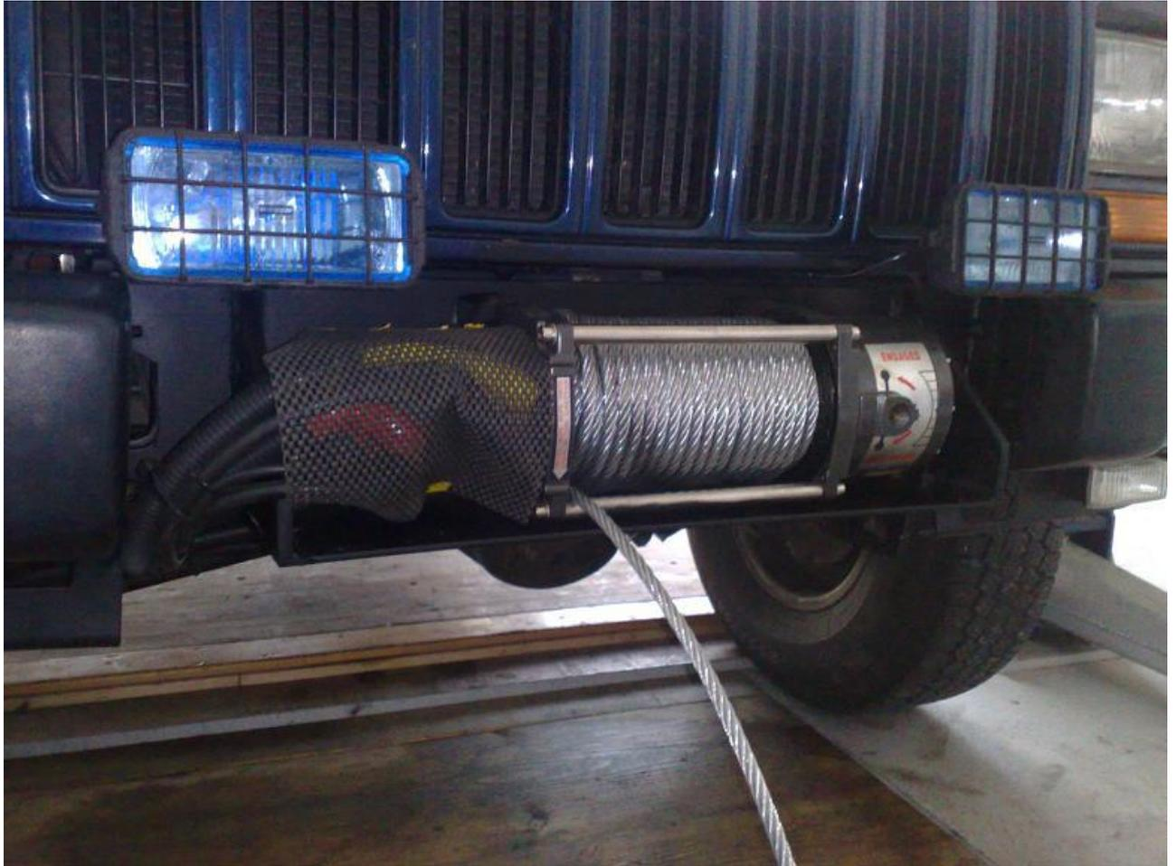
Die Winde wie sie im FrameMount hängt und links und rechts sind die originalen Plasti-Stoßstangenecken bereits montiert...
