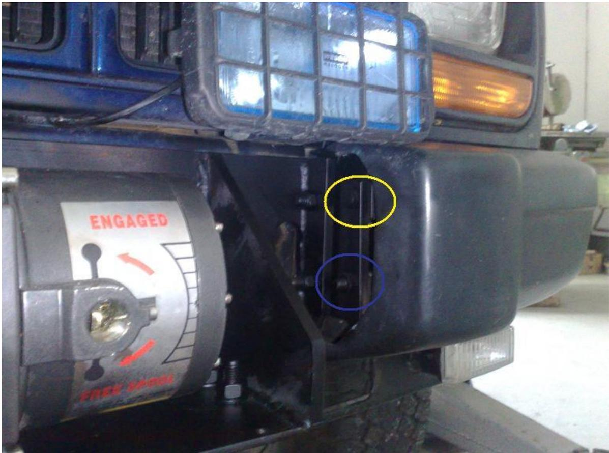
Als Befestigungspunkte haben wir die vorderen beiden Haltepunkte des Framemount verwendet, direkt auf der anderen Seite sind die Winkel angeschraubt...
