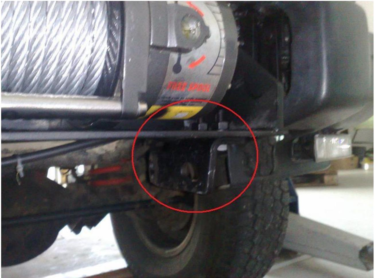
Befestigung des Abschlepphakens – das ist zumindest eine Möglichkeit diesen an der Windenhalterung zu befestigen.. allerdings sicher nicht für Höchstbelastungen ausgelegt...
