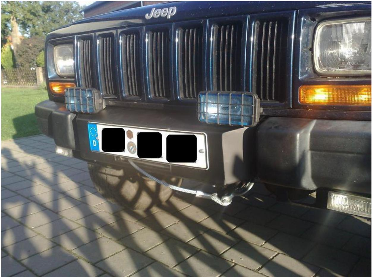
So sieht das Ganze dann fertig aus. Leider hab ich kein Bild zur Hand welches die Fertigung des Bleches zeigt, noch dieses Abmontiert, daher hab ich euch noch eine Zeichnung dazu angefertigt. Das Blech verkleidet die Winde komplett samt FrameMount.
